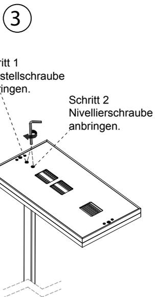
Mittels Nivellierschraube ausrichten
