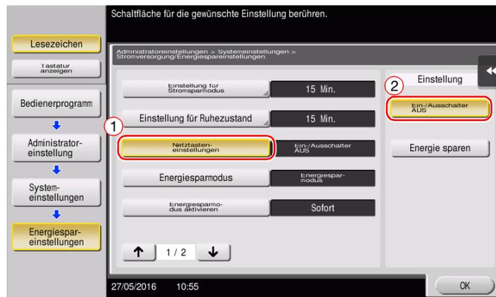
Nach dem Ändern der Einstellungen ändert sich der Stromsparmodes in Abhängigkeit davon, wie die **Netztaste** gedrückt wird.
